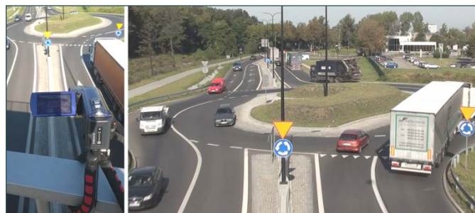
Obr. 3 Pořízení videozáznamu kamerou na stavivu umístěném na mostě
