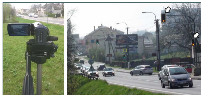
Obr. 2 Pořízení videozáznamu kamerou na běžném stavivu umístěném v úrovni vozovky
