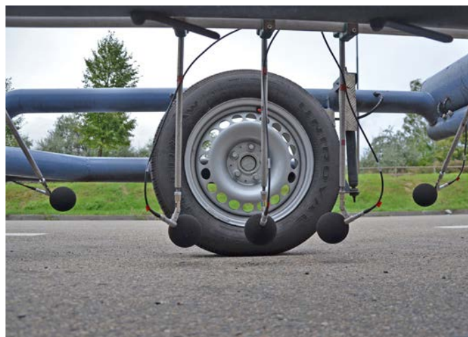
Rozmístění mikrofonů okolo referenční pneumatiky - metoda CPX
