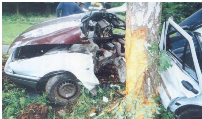
Obr. 2 Boční náraz automobilu do stromu – na boku není deformační zóna.
