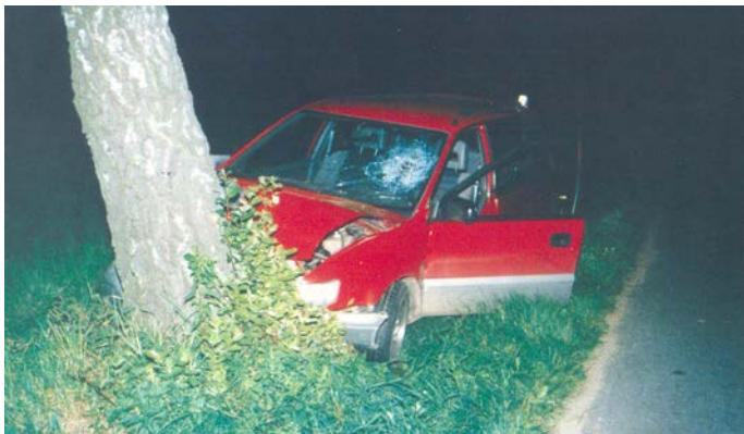
Obr. 1 Čelní náraz vozidla do stromu – rozbité čelní sklo v místě dopadu hlavy řidiče.
