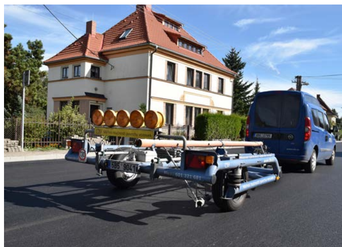
Měření hlukové libovolného povrchu vozovky - metoda CPX
