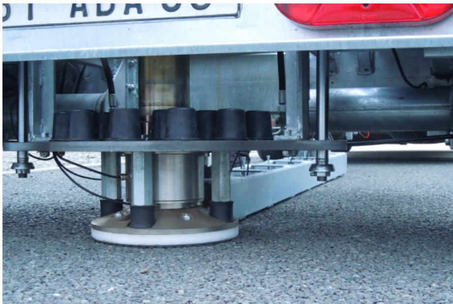
Měření průhybů na asfaltové vozovce
