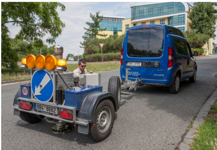
Měření průhybů rázovým zařízením FWD-HWD
